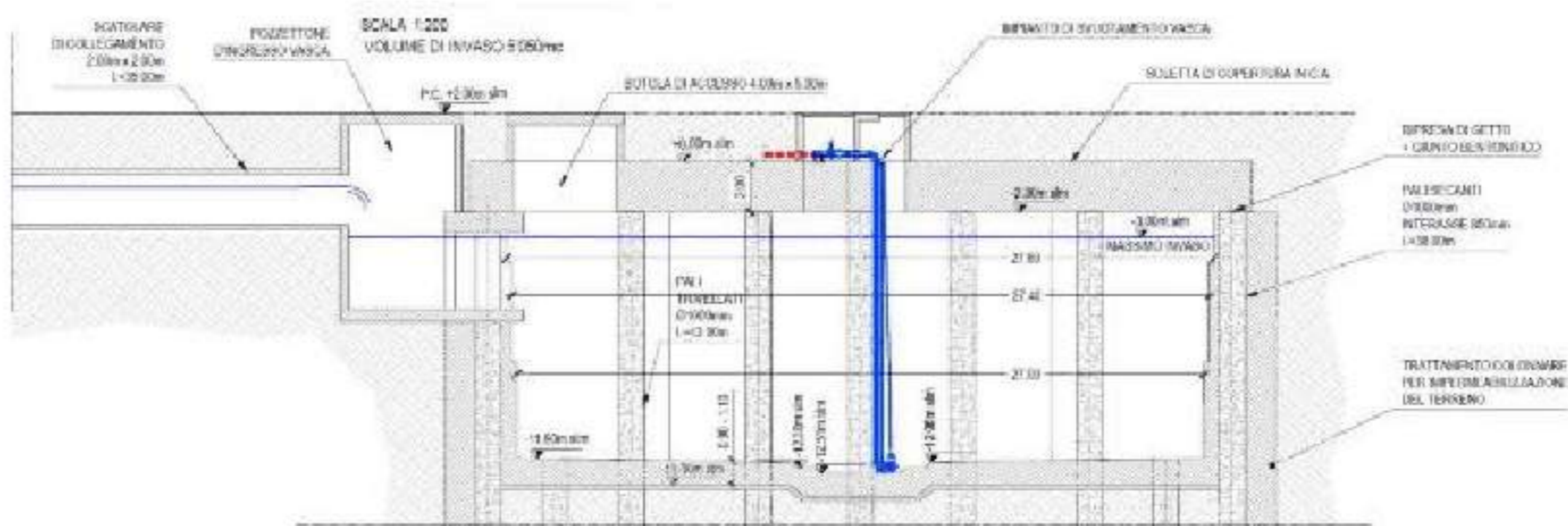
Figura 18 - Vasca di prima pioggia: sezione tipologica
