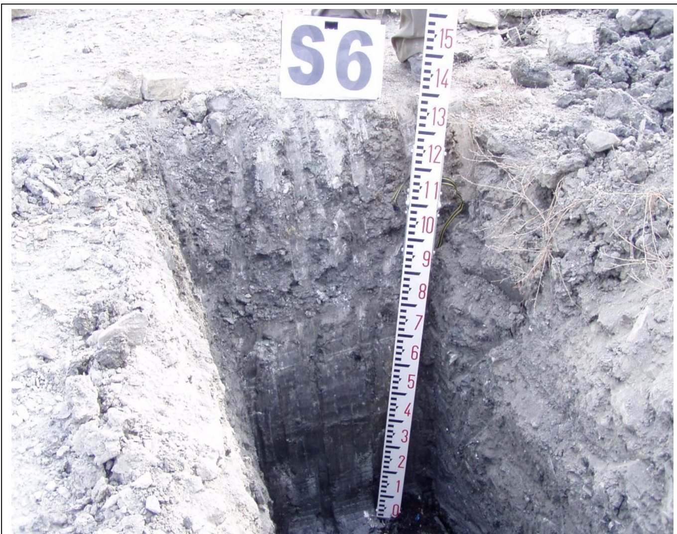
Foto 6: Realizzazione del sondaggio S6, su vasca 5 – parte alta Foto 6bis – particolare sondaggio S6 (argilla di copertura oltre 130 cm)
