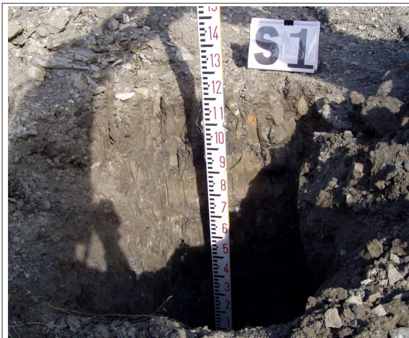
Foto 1bis – particolare sondaggio S1 (argilla di copertura superiore ad 1,1 m)
