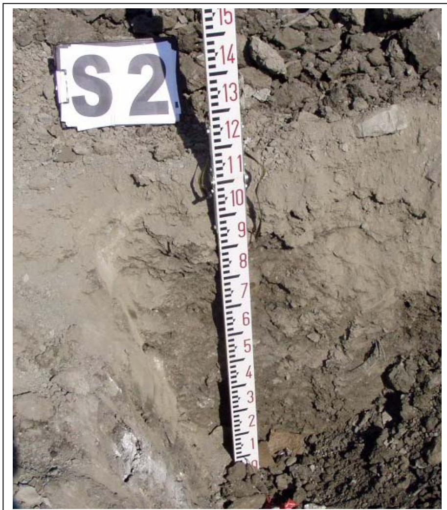
Foto 2bis – particolare sondaggio S2 (argilla di copertura circa 120 cm)
