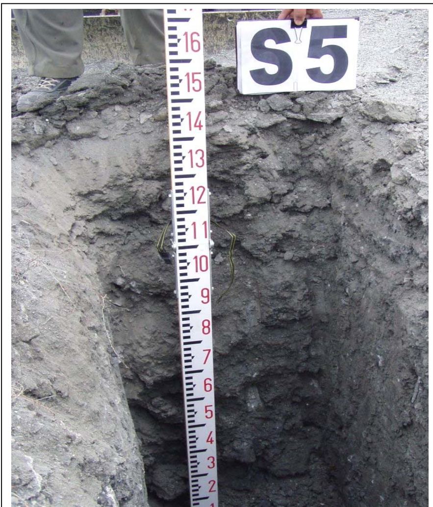
Foto 5bis – particolare sondaggio S5 (argilla di copertura oltre 160 cm)
