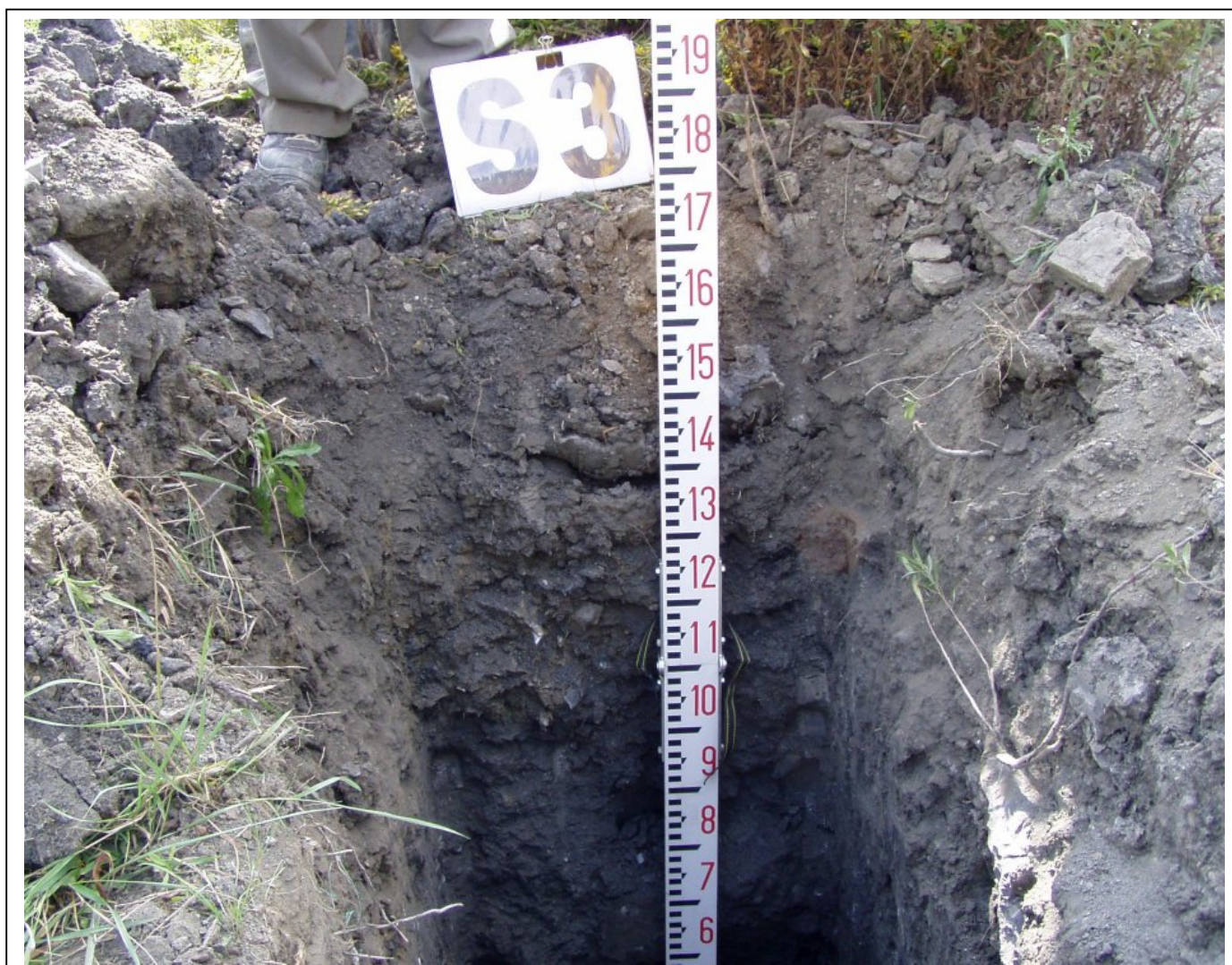
Foto 3: Realizzazione del sondaggio S3, su vasca 4 – parte bassa Foto 3bis – particolare sondaggio S3 (argilla di copertura oltre 170 cm)
