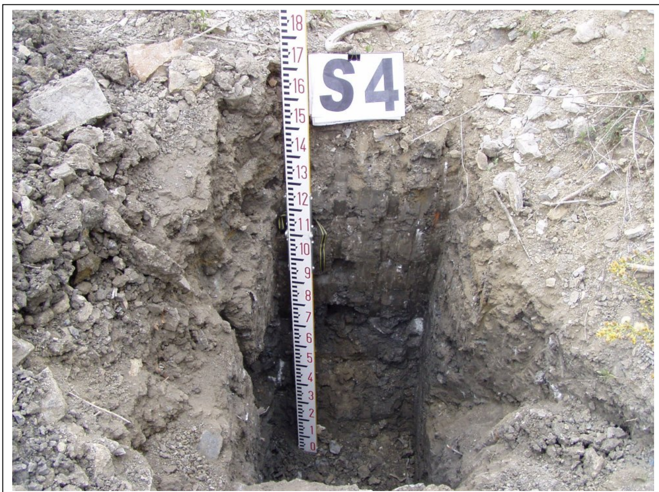
Foto 4: Realizzazione del sondaggio S4, su vasca 5 – parte bassa Foto 4bis – particolare sondaggio S4 (argilla di copertura oltre 160 cm)
