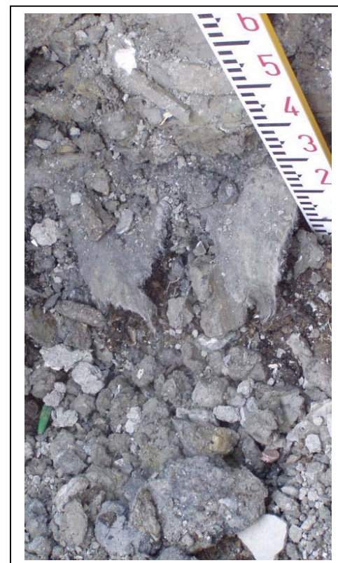
Foto 3ter – particolare del materassino drenante, rinvenuto a fondo scavo, sui rifiuti, e dello strato di compost, colore marrone scuro a pezzature fine
