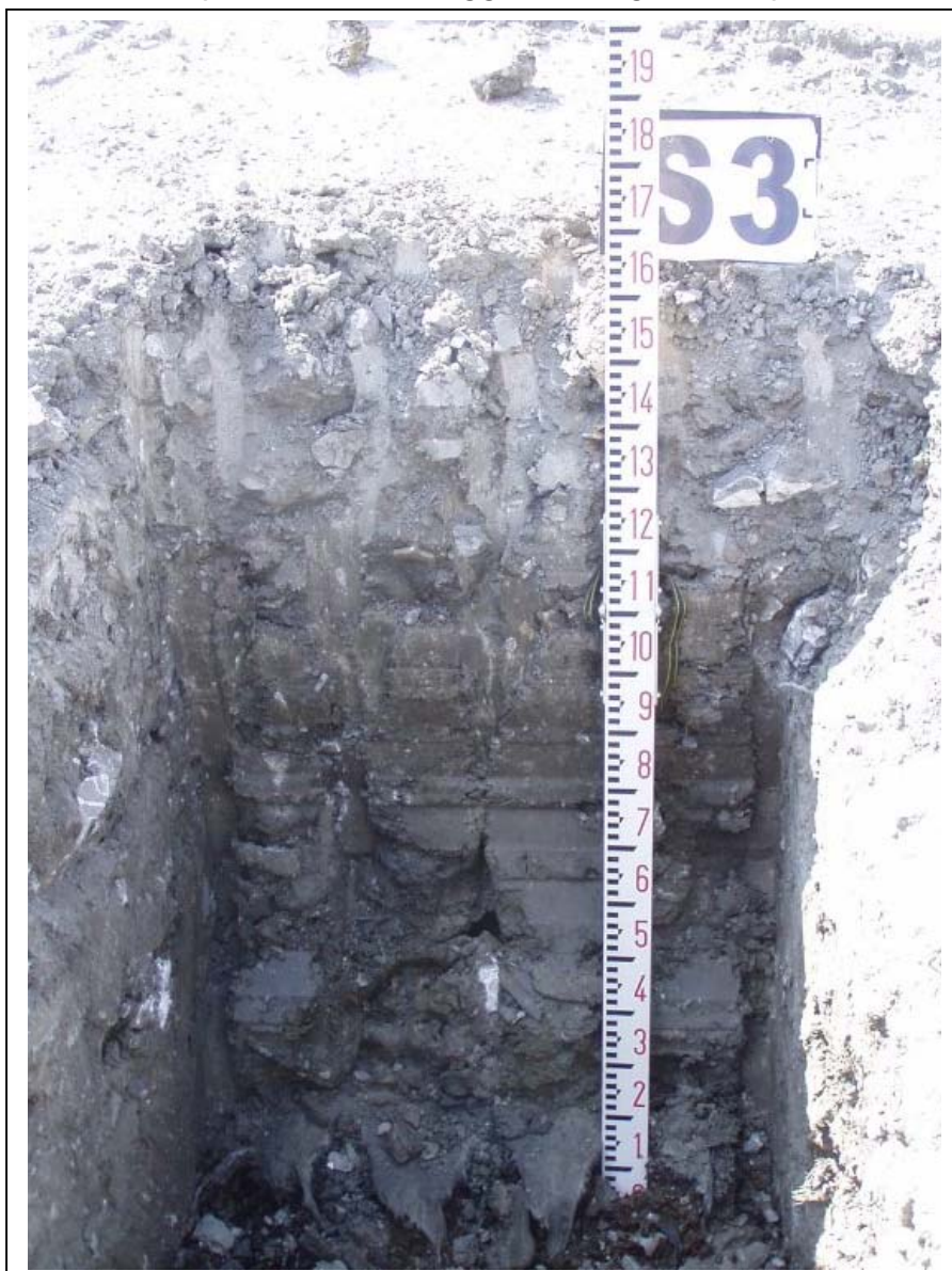
Foto 3bis – particolare sondaggio S3 (argilla di copertura oltre 150 cm)
