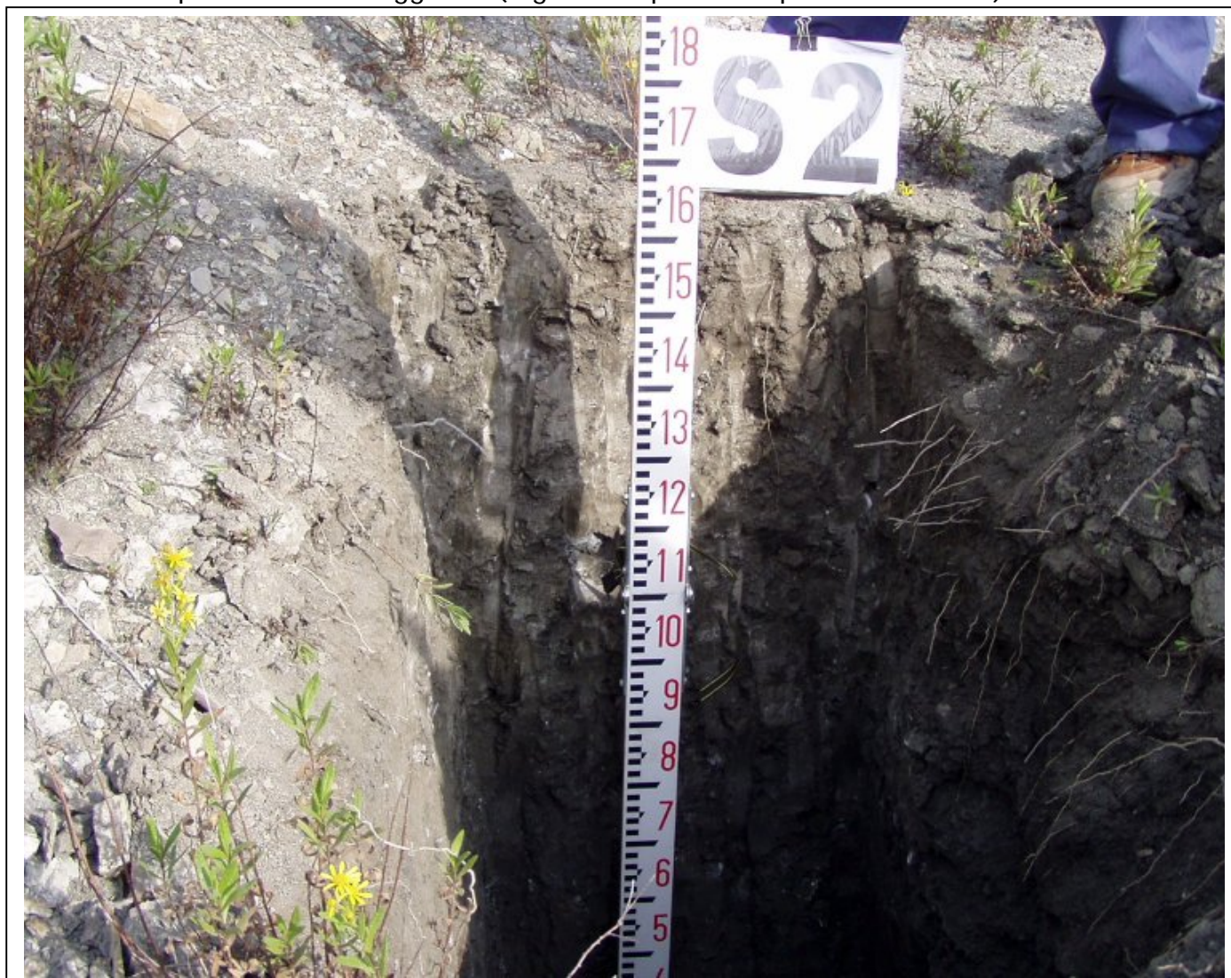
Foto 2bis – particolare sondaggio S2 (argilla di copertura superiore a 150 cm)
