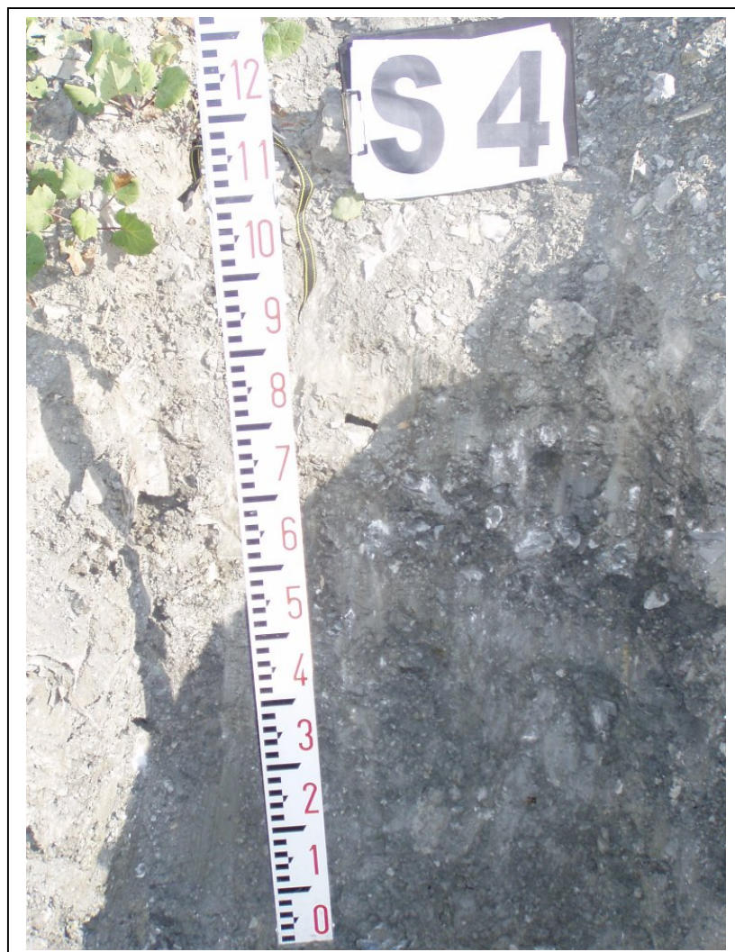
Foto 4bis – particolare sondaggio S4 (argilla di copertura oltre 100 cm)
